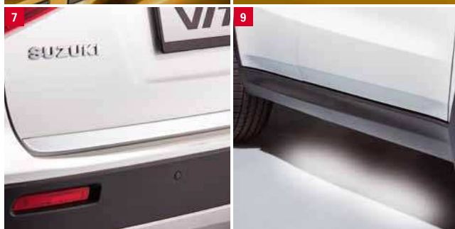
9 | Подсветка поддверного пространства. Включается при открытии передних дверей. 99000-990B4-132
